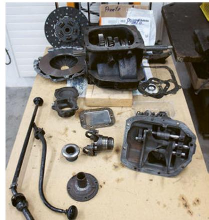
*Hauptgetriebe und Nebenantrieb zerlegt*
